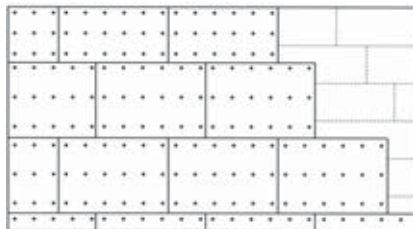
Pripevnenie dodatočnej vrstvy podlahy
